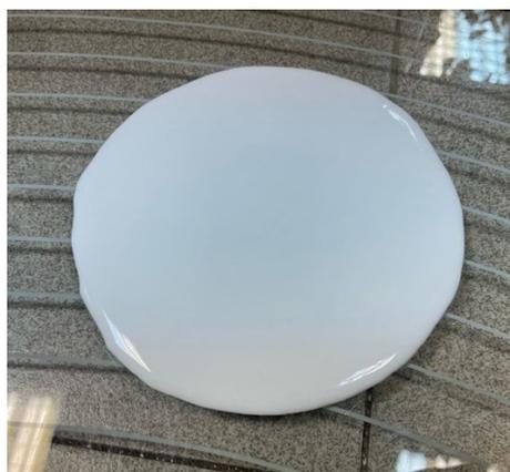
Рис. 6. Испытание литьевых смесей на растекаемость
